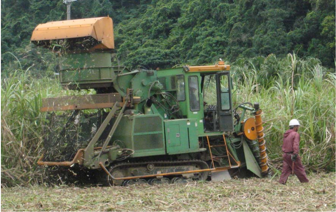
図1 小型サトウキビ収穫機 (UT-120K)
